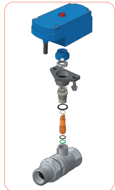
Esploso valvola a sfera con attuatore elettrico Exploded view drawing of electro-motor actuated ball valve
